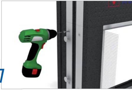
7 Collegare il modulo cassonetto e le spalle su entrambi i lati, utilizzando in ciascun caso 2 viti a testa svasata.
