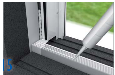
15 Applicare il collante MS 460 per tutta la lunghezza del profilo pvc inferiore a U. Tirare l'adesivo verso l'alto per circa 10 cm sulla spalla, a destra ed a sinistra.
