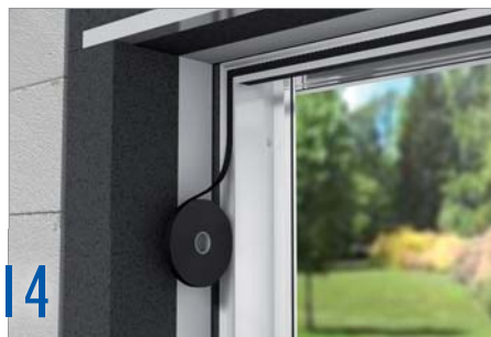
14 Nel profilo scanalato in PVC inserire ed incollare il nastro sigillante precompresso (utilizzare esclusivamente un nastro sigillante tipo 15/3-7 compriband).
