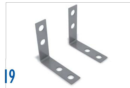
19 Nel caso di elementi che vengono montati nel piano di isolamento, utilizzare degli angolari (forniti, a richiesta, da B+H) per il trasferimento del carico sotto l'elemento avanzante della finestra ed anche per contrastare l'inclinazione dell'elemento architrave dell'avvolgibile.
