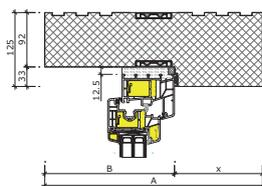
Fig.: muratura monolitica e sistema a cappotto
